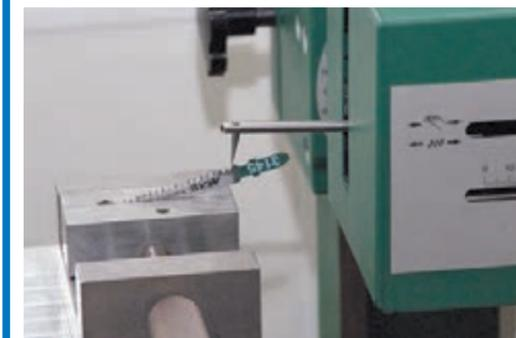
**KONTUROSOP:** Mit diesem Instrument kann die Zahnung exakt vermessen werden. Eine feine Nadel tastet dafür die Zahnung genau ab und erstellt ein Abbild der Zahngeometrie.
