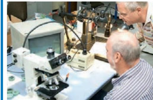
**MIKROSKOP:** Oberfläche und Verarbeitungsgüte der Zahnung ließen sich am Mikroskop am besten beurteilen. Kleinere Ungenauigkeiten schlugen sich beim Sägen jedoch nicht erkennbar nieder.
