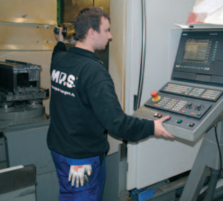
Ein MPS Sägen-Mitarbeiter richtet ein Fräszentrum ein, das die Sägeblätter vollautomatisch in die richtige Form fräst. Beim Lasern fliegen die Funken – das Basis für die Herstellung sind Stahlrollen. Am Ende des Produktionsprozesses sind die MPS-Sägeblätter aus Wasserliesch verkaufsfertig verpackt und bereit für
