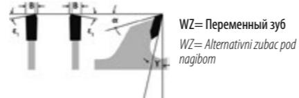
Пильный диск с твердосплавными зубьями
