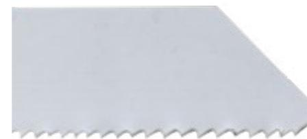
Классическая форма полотна для сабельной пилы – полотно заканчивается острием – не очень подходит для распила паллет, т.к. при касании острием гвоздя полотно поворачивается беззубым краем и быстро застrevает в разрезе. В итоге полотно надламывается или вовсе ломается, и его нужно менять на новое.
