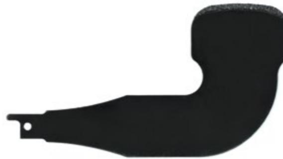
Скребок с напылением из твердого сплава для использования с сабельной пилой. Применяется для удаления старой затирки швов с целью обновления керамической плитки. Намного чище и безопасней, чем с помощью шлифовальной машины!
