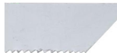
Обычная форма полотна для сабельной пилы – с так называемой реверсной вершиной, т.е. с вершиной «наоборот» (смотрящей в обратную сторону) – больше подходит для распила паллет, т.к. при касании гвоздя оно поворачивается краем с зубьями. Это полотно проходит «тупую» штамповку с торцом 0,9 – 1,27 мм. Погружение этого полотна в место соединения дерева и гвоздя невозможно.
