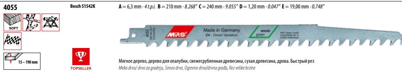
A = 6,3 mm · 4 t.p.i. B = 210 mm · 8.268" C = 240 mm · 9.055" D = 1,20 mm · 0,047" E = 19,00 mm · 0,748"
